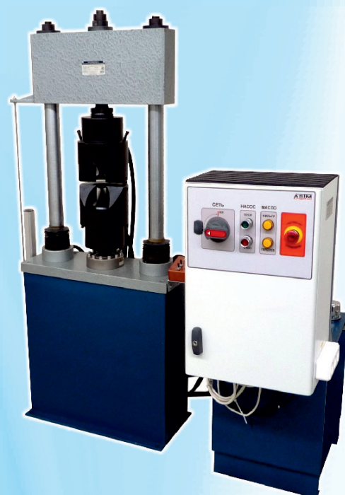
Модернизация машины МР-100 до уровня ИР-100М-авто
