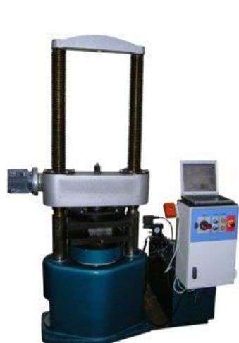
Модернизация пресса П-125 системой ASTM-Digital «Профессиональная» до уровня ИП-1250М-авто
