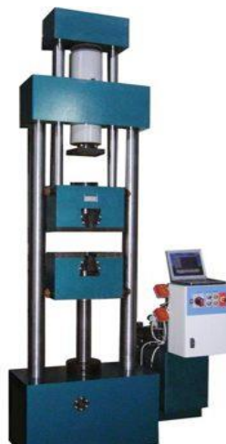
Модернизация машины Р-50 системой ASTM-Digital «Профессиональная» до уровня Р-50М-авто
