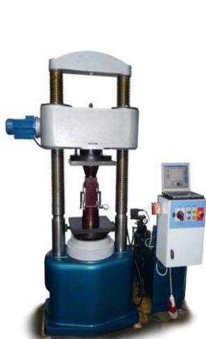
Модернизация пресса ПСУ-250 системой ASTM-Digital «Профессиональная» до уровня ИП-2500М-авто
