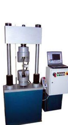
Модернизация машины МР-100 системой ASTM-Digital «Профессиональная» до уровня ИП-100М-авто
